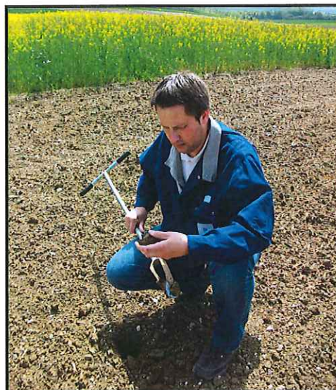
Fig. n° 46 : Sondage pédologique à la tarière
